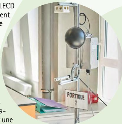
**Station microclimatique pour la caractérisation du confort de l'occupant.**
