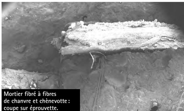
Mortier fibré à fibres de chanvre et chènevotte : coupe sur éprouvette.
